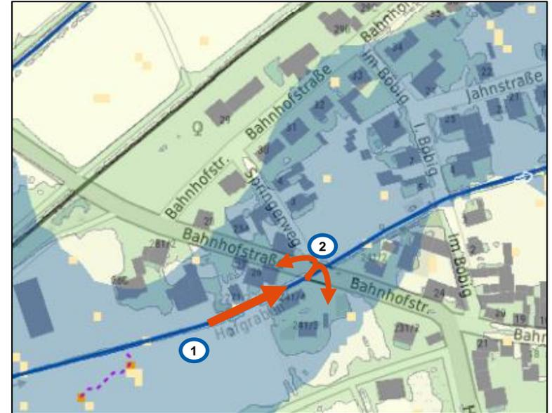
→ Hydraulischer Engpass, aufgrund Ausbildung (Verbau) leistungsfähig, aber sehr anfällig für Verkläuserung und dann Überschwemmung „2“.
