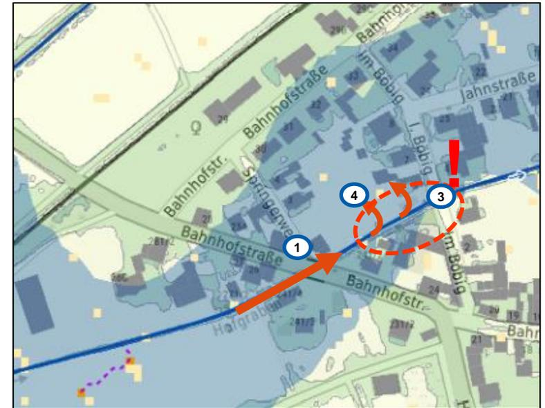
→ Hydraulischer Engpass „3“ sehr anfällig für Verklüsung und dann Überschwemmung „4“.
