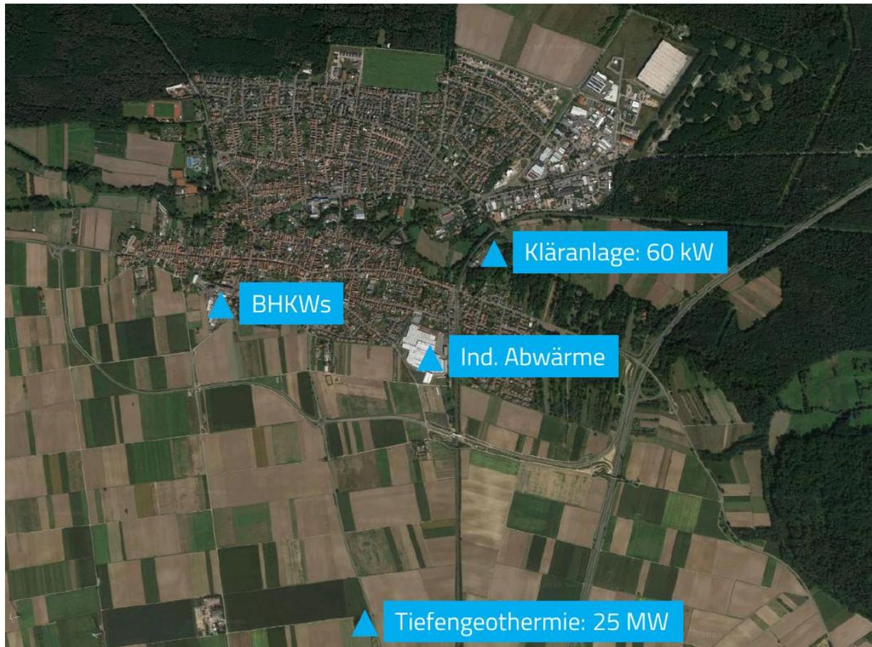
Abbildung 72: Potenzielle Energiequellen für Wärmenetz Bellheim
